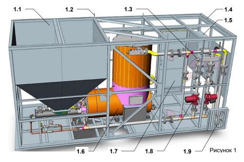
Котельные Терморобот поставляются в виде блоков заводской готовности, всё входящее в них оборудование смонтировано в рабочем положении и подключено согласно схемам.
